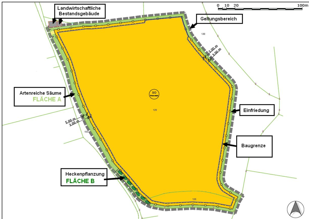
**Abbildung 2:** Planskizze der Planungsfläche mit Einfriedungen, geplanten Grünflächen (Fläche A) und Heckenpflanzungen (Fläche B) (Quelle: vorläufiger Bebauungsplan)
